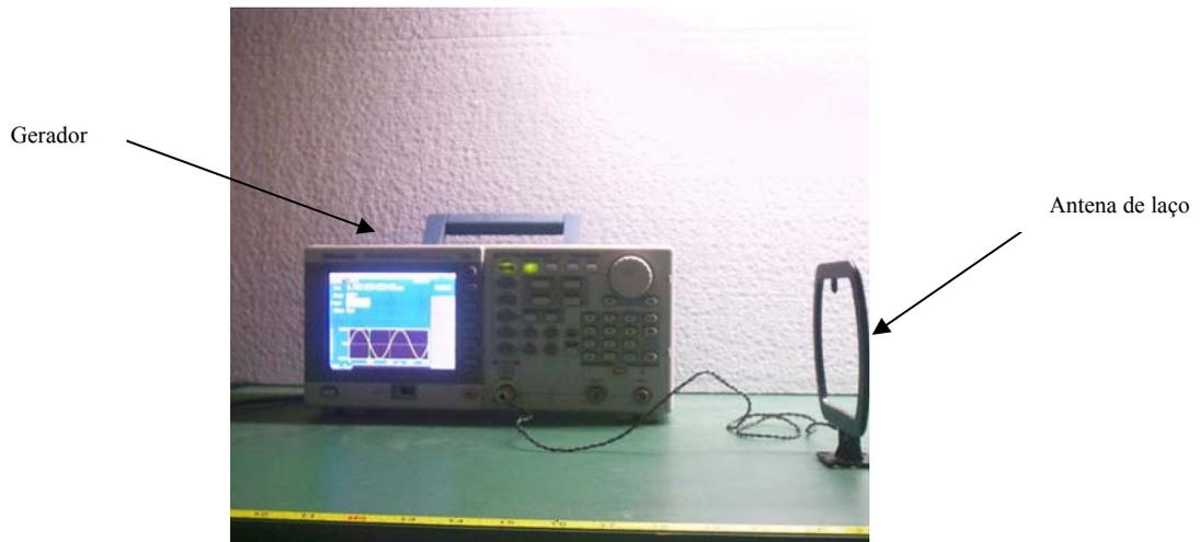
Figura 2.25 - Unidade de geração de RF para testes com a sonda.
