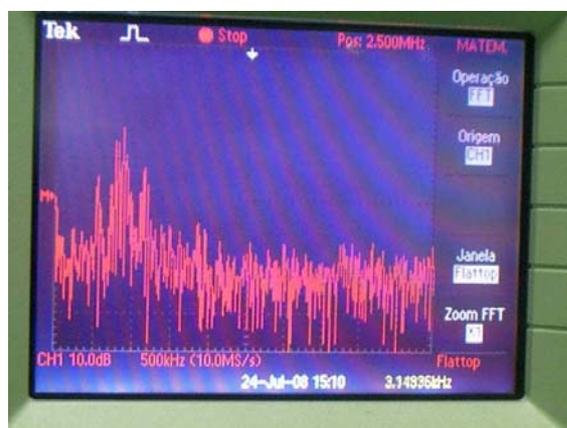
Figura 3.25 (a) - FFT do sinal em campo-distante capturado pela sonda ressonante em torno de 1 MHz em tempo real (3º estágio de desenvolvimento)
