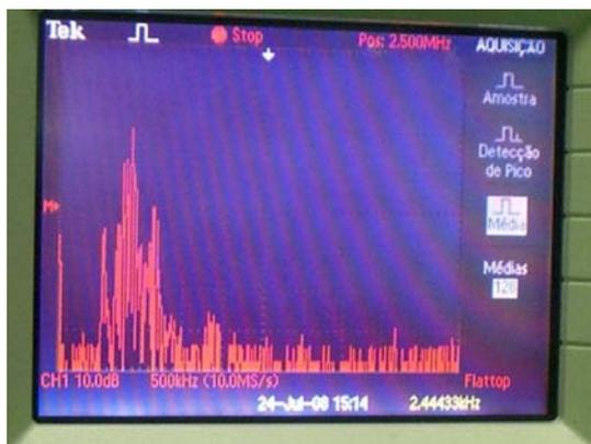
Figura 3.25 (b) - FFT do sinal em campo-distante capturado pela sonda ressonante em torno de 1 MHz promediado com 128 amostras (3º estágio de desenvolvimento).
