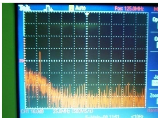
Figura 3.11 (c) - FFT do sinal (10 dB/div e 25 MHz/div - 2º estágio de desenvolvimento) .
