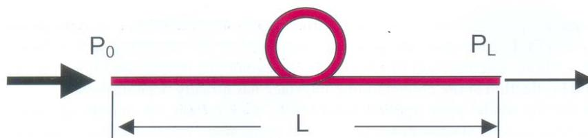
Figura 2.19 - Definição de atenuação em uma fibra óptica [28].
