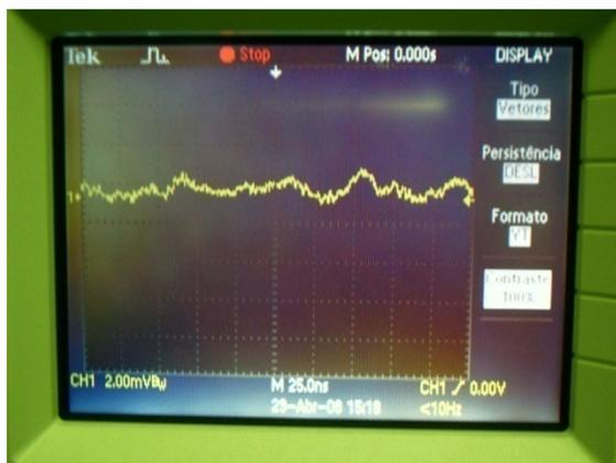
Figura 3.11 (b) - Linha de base com acoplamento óptico defeito para o sinal de 30,9 MHz (2º estágio de desenvolvimento)..
