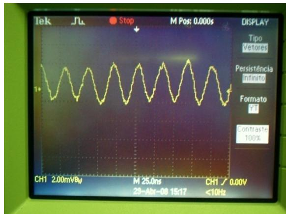
Figura 3.11 (a) - Formato de onda no osciloscópio (2 mV/div e 25 ns/div) do sinal de RF em 30,9 MHz demodulado no tempo (2º estágio de desenvolvimento).
