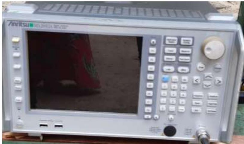
**Figura 25 - Analisador de Espectro *Anritsu MS2692A*.**
