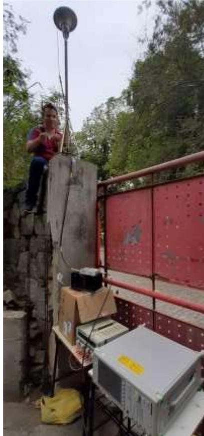
**Figura 21 - Antena transmissora na altura de 4,2 m.**
