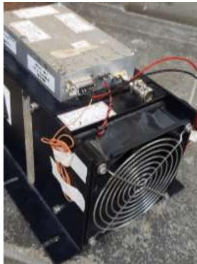
**Figura 23 - Amplificador de Potência: Mini-circuits ZHL-16W-43+.**
