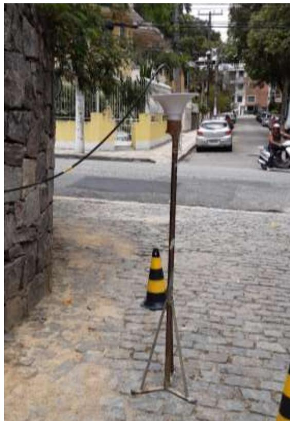
**Figura 20 - Antena transmissora na altura de 1,7 m.**
