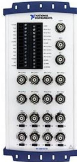
Figura 35 - Interface de aquisição NI USB-6212 BNC
