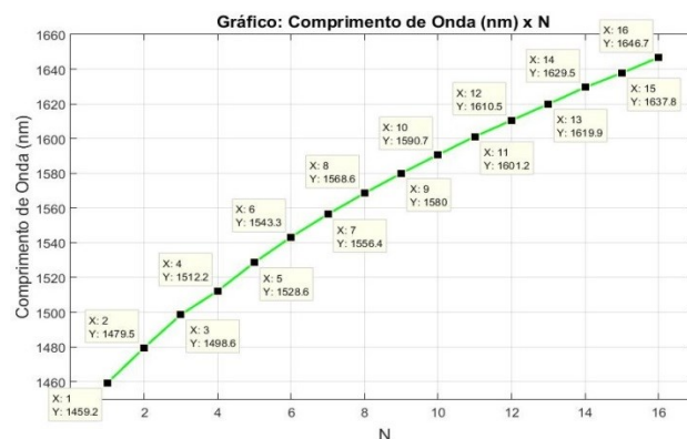
Fig. 3. Espaçamento entres os 16 picos em comprimento de onda gerados dentro da banda 1450-1650 nm.
