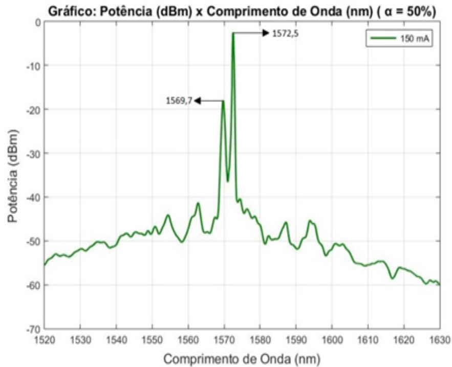
Figura 5.18 Espectro de emissão CW do laser em anel com filtro MMI inserido baseado na estrutura SMS com MS, para uma corrente de polarização do SOA em 150 mA, usando um acoplador 50/50.
