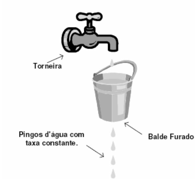
**Figura 18:** O método do balde furado – água
