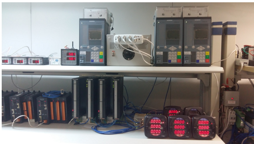
Figura 32 - Rede de testes 2: Arranjo físico
