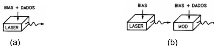
Figura 2.4: Esquemas de modulação de fontes ópticas. (a) Modulação direta. (b) Modulação externa.
