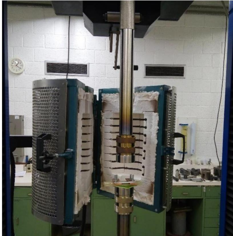
**Figura 3.21 ± Forno elétrico e máquina de compressão**
