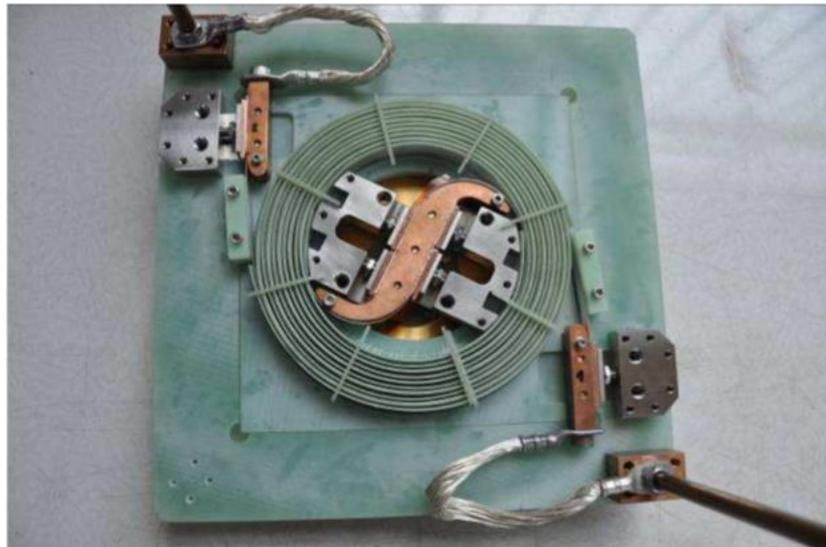
**Figura 2.17 ± Protótipo do componente supercondutor do Ensystrub. [18]**
