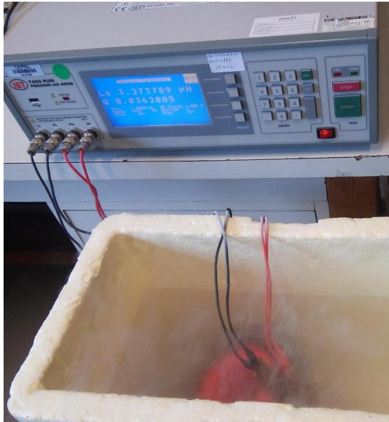
**Figura 5.29 ± Uso de ponte de medição para determinação dos parâmetros do LCSR**
