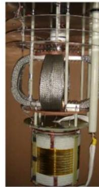
b) Bobinado e sistema de refrigeração
