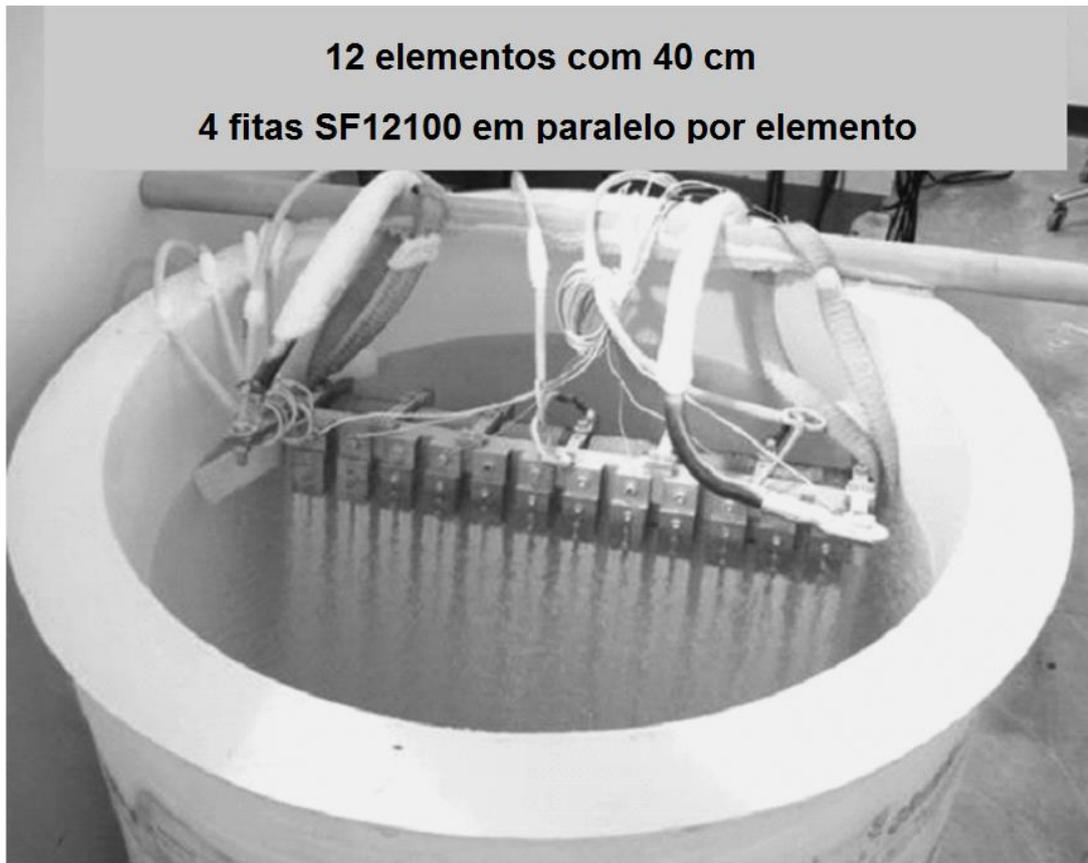
**Figura 3.3 ± Foto do módulo com 12 elementos de fita SF12100 imerso em nitrogênio. [21]**
