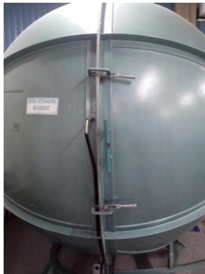
Figura 9 - Esfera integradora de Ulbricht.
