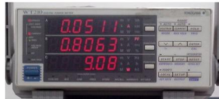
Figura 12 – Wattímetro.
