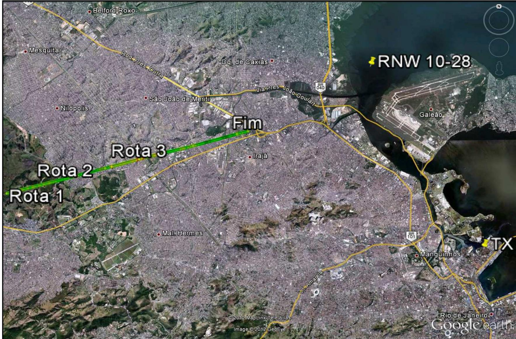
Figura 5.21: Visão 2D das Rotas 1, 2 e 3 – Aproximação para pouso no Aeroporto Galeão (L = 11.635,74 m).
