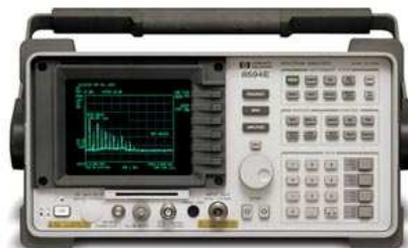
Figura 5.11 - Analisador de espectro 8594E.
