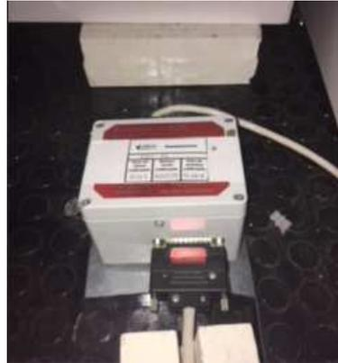
Figura 23 – Equipamento CDN utilizado durante o ensaio de perturbação radiada (campo elétrico).
