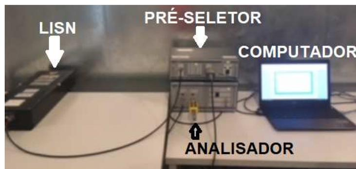
Figura 21 – Configuração dos equipamentos utilizados durante a medição das tensões de perturbação nos terminais de alimentação das luminárias.
