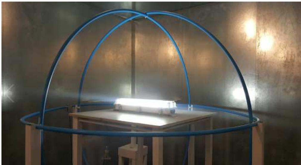
Figura 39 – Ensaio de perturbações eletromagnéticas radiadas (Campo Magnético).
