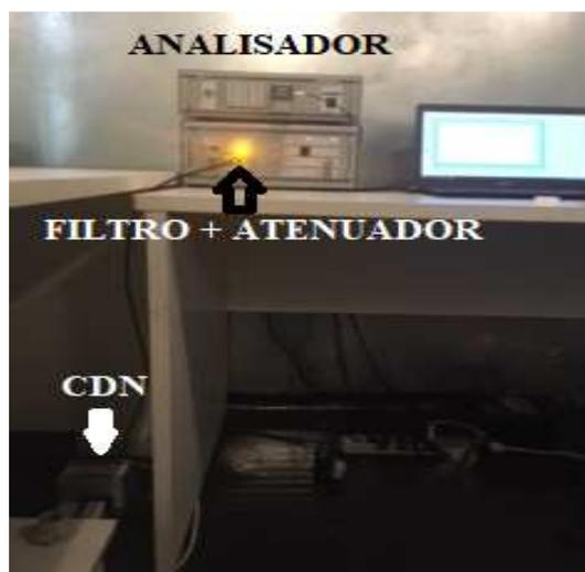
Figura 22 – Configuração dos equipamentos utilizados durante a medição de perturbações radiadas (campo elétrico) das luminárias.
