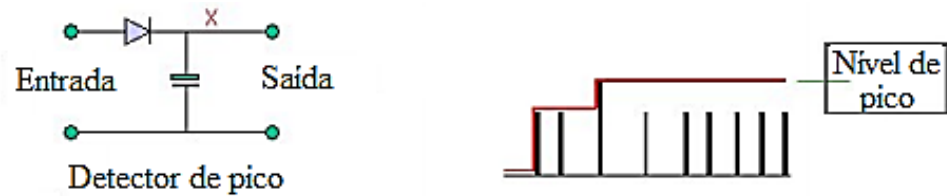
Figura 15 – Princípio de funcionamento do detector de pico (Adaptado de [101])
