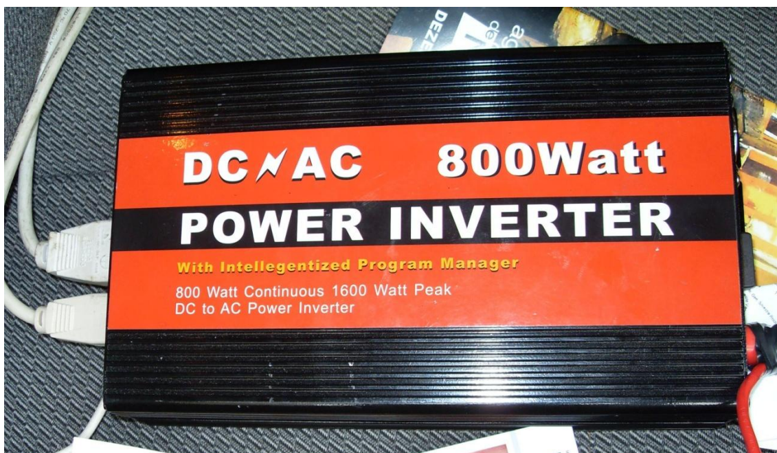
Figura 5.14 – Inversor de tensão
