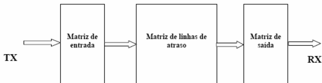
Figura 4.3 – Estrutura Geral do Canal SUI
