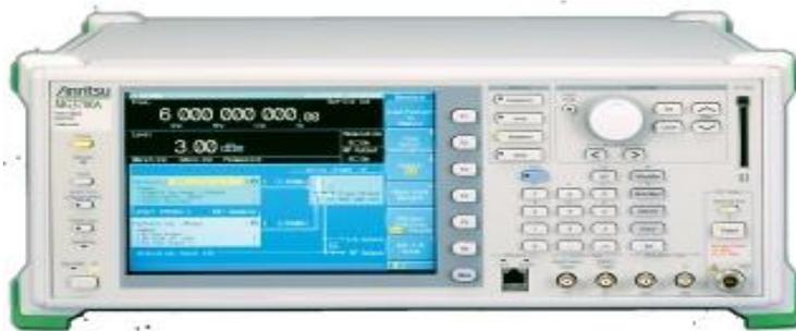
Figura 2.15– Gerador MG 3700A utilizado na transmissão.
