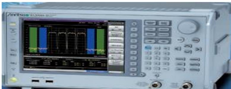
Figura 2.16– Analisador MS 2962A utilizado na recepção
