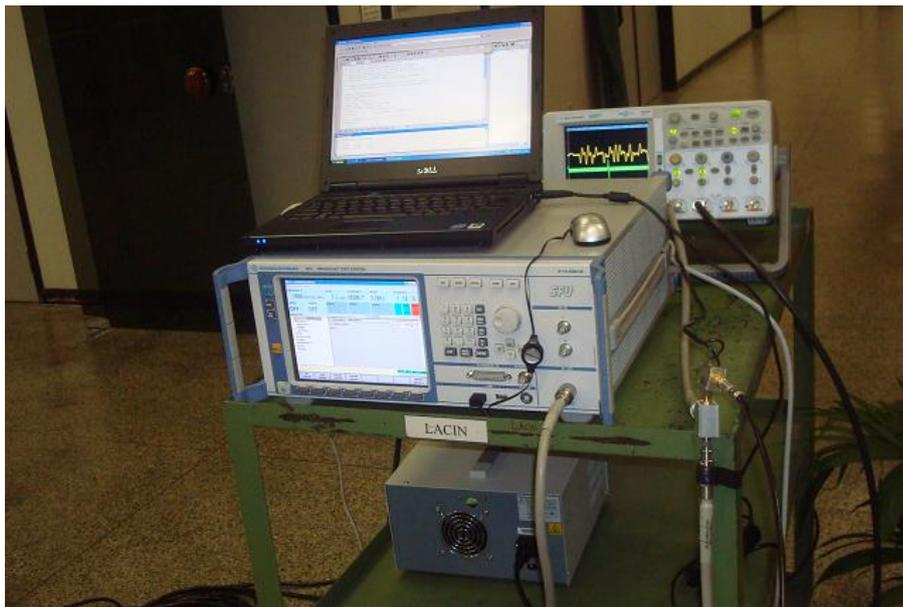
Figura 5.6: Fotografia do sistema de recepção da sonda.
