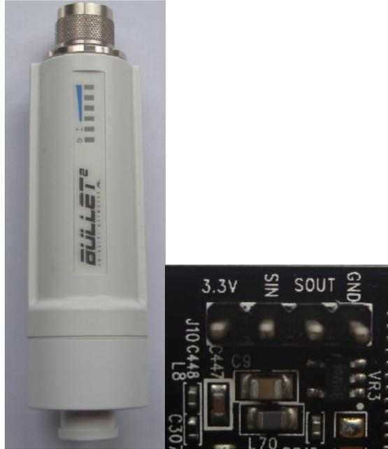
Figura 4.23 – Detalhe da interface serial do Bullet2
