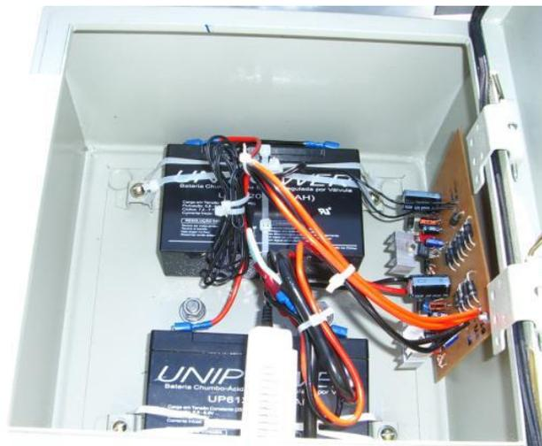
Figura 2.7 – Controlador de carga desenvolvido na USP
