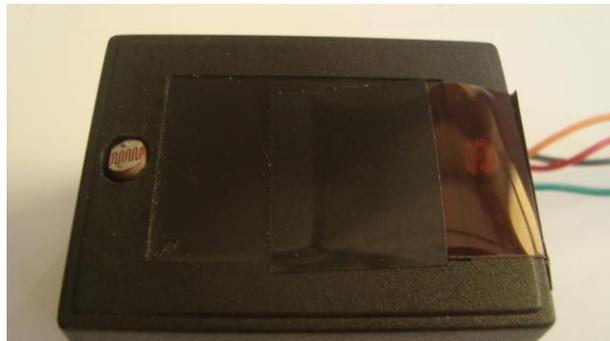
Figura 5.26 - LDR's sem filtro e com filtro
