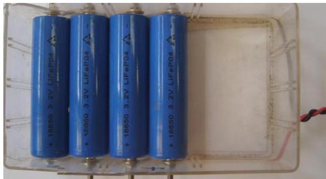
Figura 5.22 – Células  $\text{LiFePO}_4$  em série
