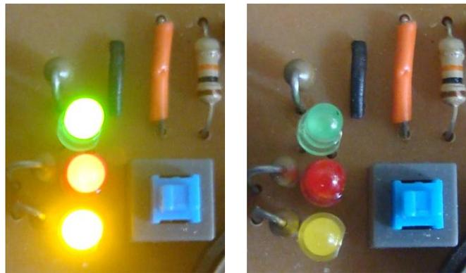
Figura 5.24 – Detalhe dos leds antes e depois da utilização da chave
