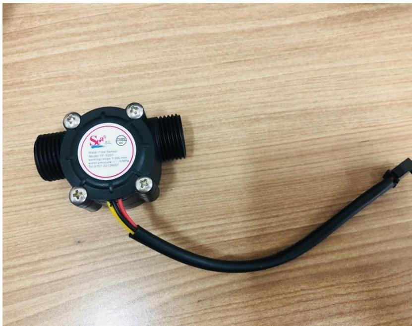
Figura 12: Sensor de vazão YF-S201 (Fonte: Autor)
