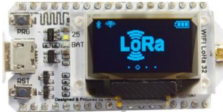
Figura 15: ESP 32 LoRa (Fonte: Folha de dados do fabricante - Heltec).
