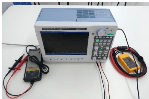
Figura 57 - Ponteiros de tensão e corrente e oscilógrafo modelo DL850EV da Yokogawa [125].
