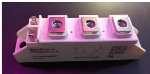
Figura 51 - Tiristor do modelo TT120N16SOF [121].
