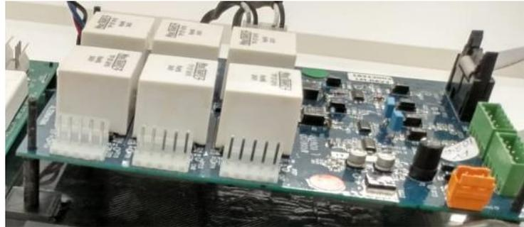
Figura 52 – *Driver* de acionamento dos tiristores.
