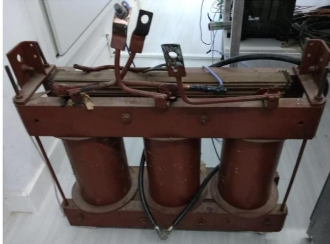
Figura 60 - Transformador de 75 kVA utilizado nos ensaios.
