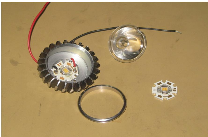
Figura 34 – LED e montagem do dissipador
