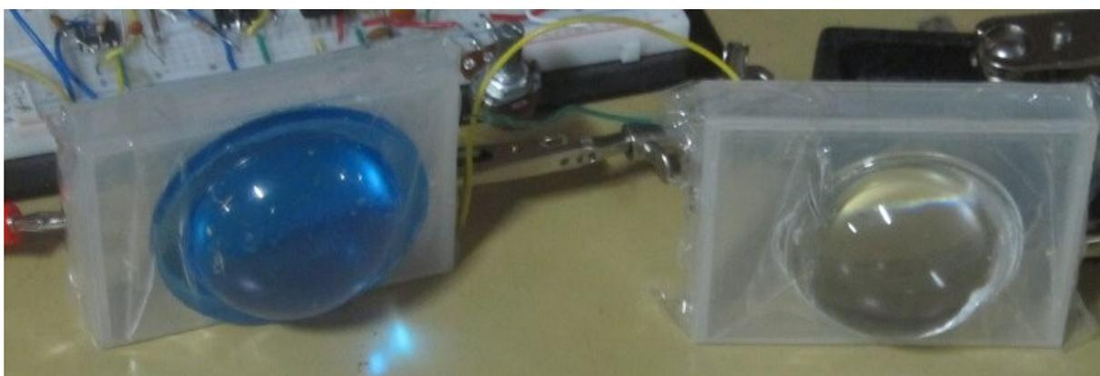
Figura 39 – montagem do fotodetector com lente
