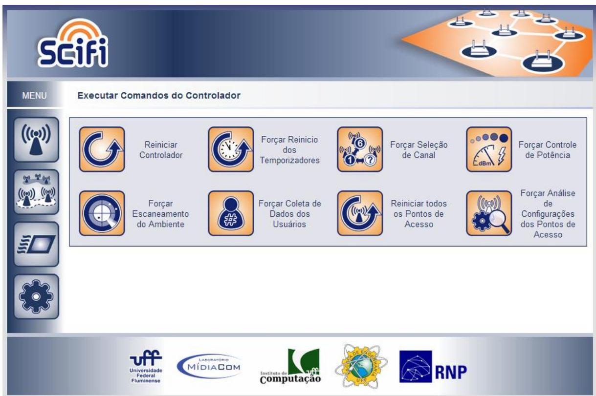
**Figura 21. Execução de comandos do controlador via interface Web**
