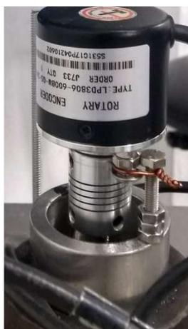
Figura 3.17 – Encoder rotativo incremental utilizado.
