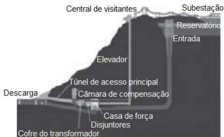
Figura 2.5 - Sistema de energia por bombeamento hidráulico, adaptado de [14].
