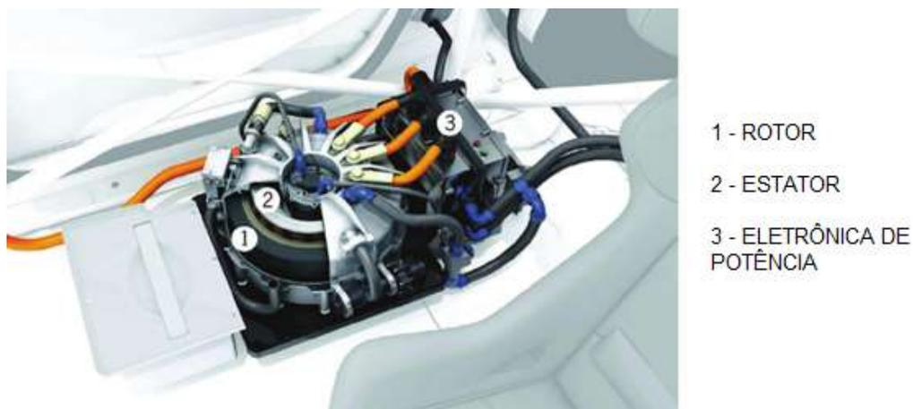
Figura 2.12 – Dispositivo SAEC para veículos híbridos, adaptado de [20].
