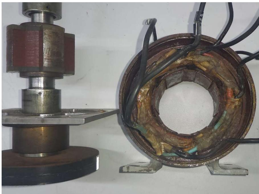
Figura 3.4 - Rotor e estator da MRV
