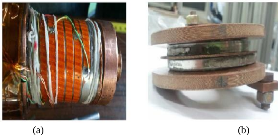
Figura 2.13: Arranjos de bobinas: (a) bobina solenóide e (b) bobina tipo panqueca [4].
