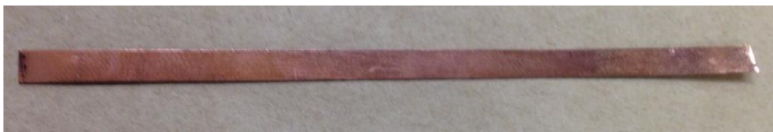
Figura 4.6: Fio de cobre utilizado no enrolamento da bobina NIC.
