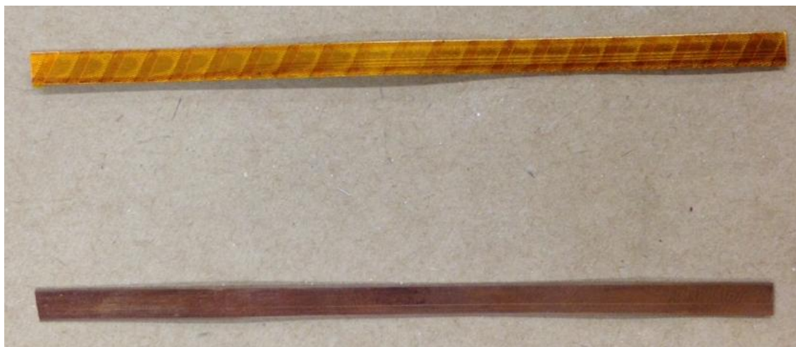
Figura 4.7: Fio supercondutor da SuNAM com e sem Kapton.
