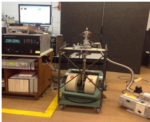
Figura 3.14: Sistema de caracterização de fios supercondutores com campo magnético incidente.
