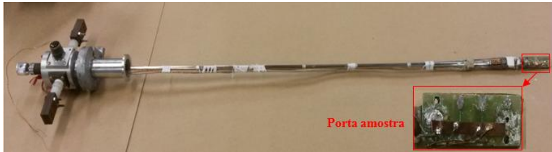
Figura 3.15: Criostato aberto mostrando o porta amostra.
