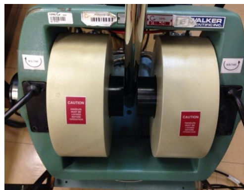
Figura 3.12: Eletromagneto com refrigeração a água.
