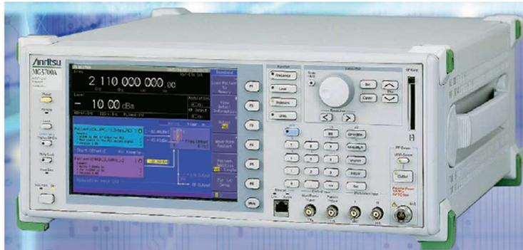
Figura 38 - Gerador Vetorial de Sinais, modelo MG3700A.
