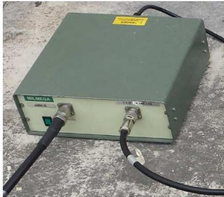
Figura 32– Amplificador de potência, para faixa de 2,5 GHz.
