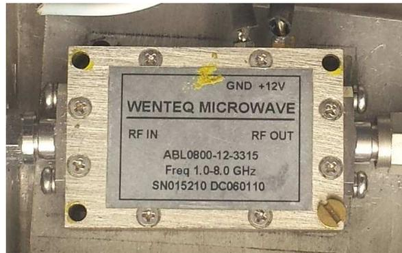
Figura 37 - LNA para faixa de 5,8 GHz.
