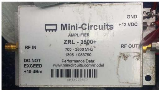
Figura 35 - LNA para faixa de 2,5 GHz.
