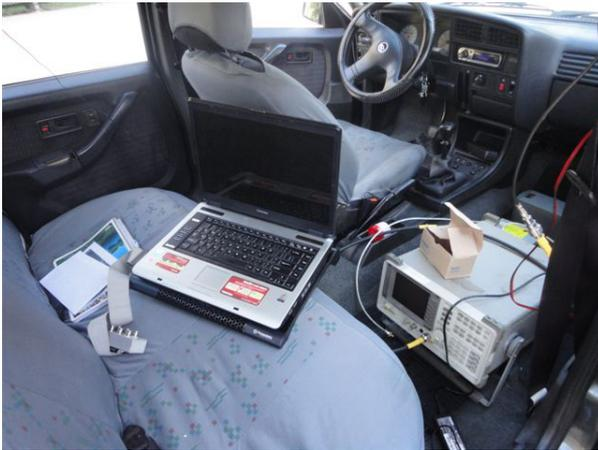
(a) Componentes dos blocos de recepção, aquisição e armazenamento montados no interior do veículo
