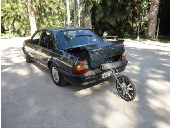
(a) Foto da roda de bicicleta montada no veículo
