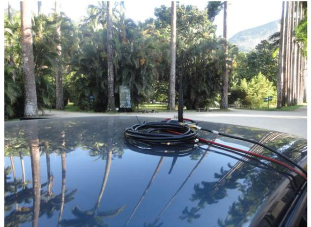
(b) Antena receptora e LNA fixados no topo do veículo
