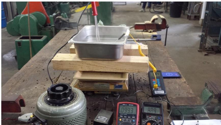
**Figura 19: Montagem das medições para caracterização do ebulidor.**
