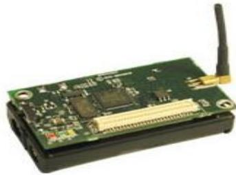
Figura 1a. *Mote* modelo MicaZ
