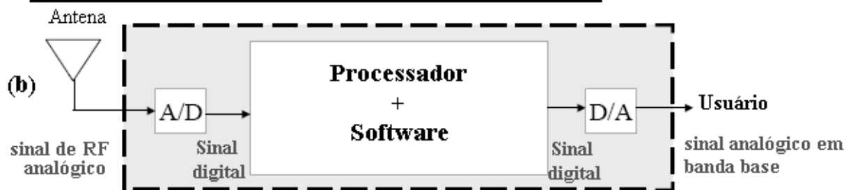
Figura 2.1 - Equipamento de rádio: paradigma baseado em hardware (a) versus paradigma baseado em software (b) .
