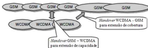
Figura 3.11: Hard handover entre sistemas diferentes (Ex: WCDMA e GSM)
