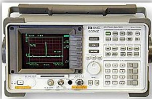
Figura 3.19: Analisador de espectro: HP8594E.
