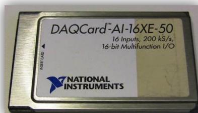
Figura 3.20: Placa de aquisição: DAQCARD-AL-16XE-50.
