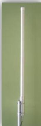
Figura 3.13: Antena transmissora de 900 MHz.
