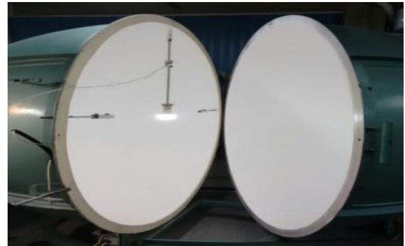
Figura 28 – Esfera integradora Ulbricht
